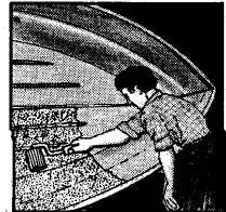
Glasfiberen lægges i den endnu våde polyester og rulles omhyggeligt med metalrulle
